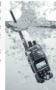
※1 バッテリーパック、アンテナ、保護カバーを正しく装着した状態で、試験用粉塵を1㎡あたり2kgの割合で浮遊させた中に8時間放置したのちに取り出して、無線機の内部に粉塵の浸入がないこと。また、水深1mの静水(常温の水道水)に静かに沈め、30分間放置したのちに取り出して、無線機として動作することです。また、一定の条件下における水滴や噴流、粉塵によっても無線機として動作することを表します。
